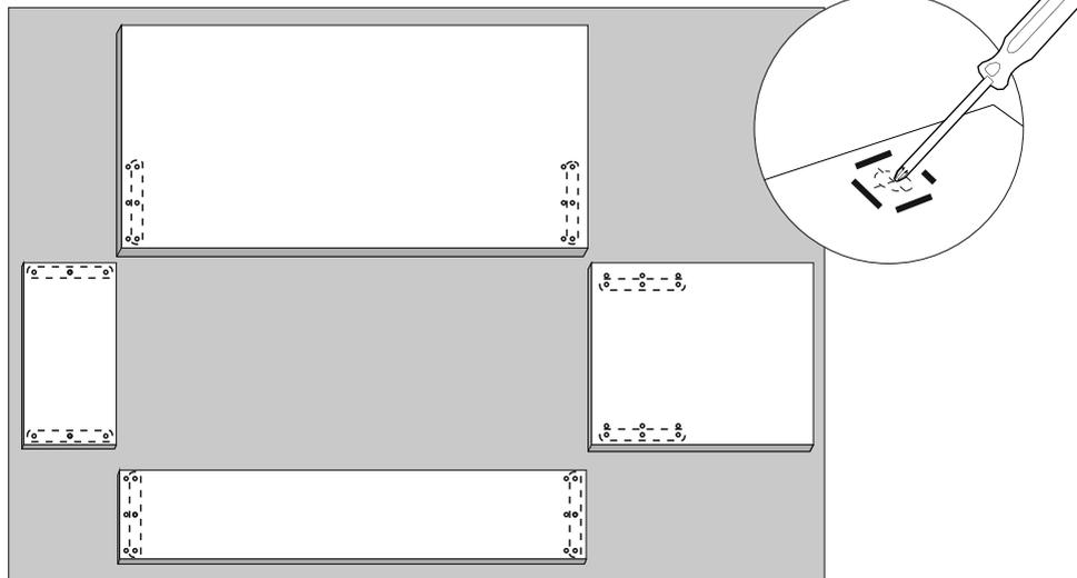
На схеме отмечены отверстия для сборки
