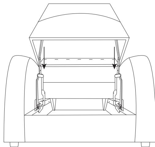
Надеваем направляющие спинки на механизм.
